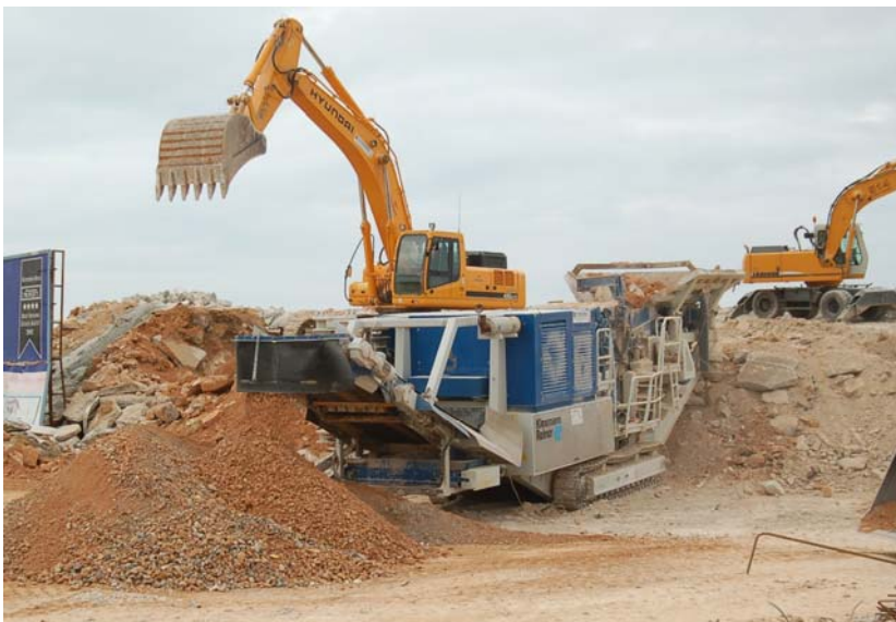
Figura 5. Planta móvil de machaqueo
