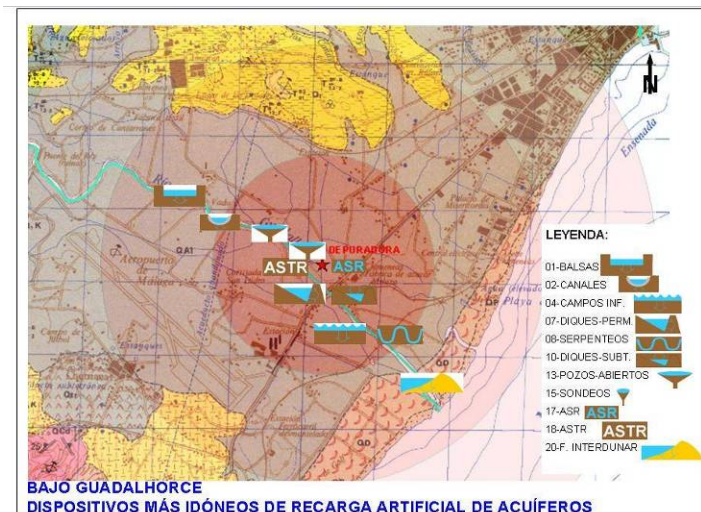
Figura 10. Acuífero del Bajo Guadalhorce. Propuesta de la ubicación de dispositivos para la recarga artificial de acuíferos de acuerdo con el sistema matricial de rangos-pesos que hemos designado DINA-MAR.
