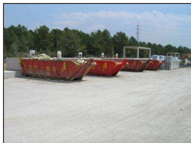
Punto Limpio de RCD's
