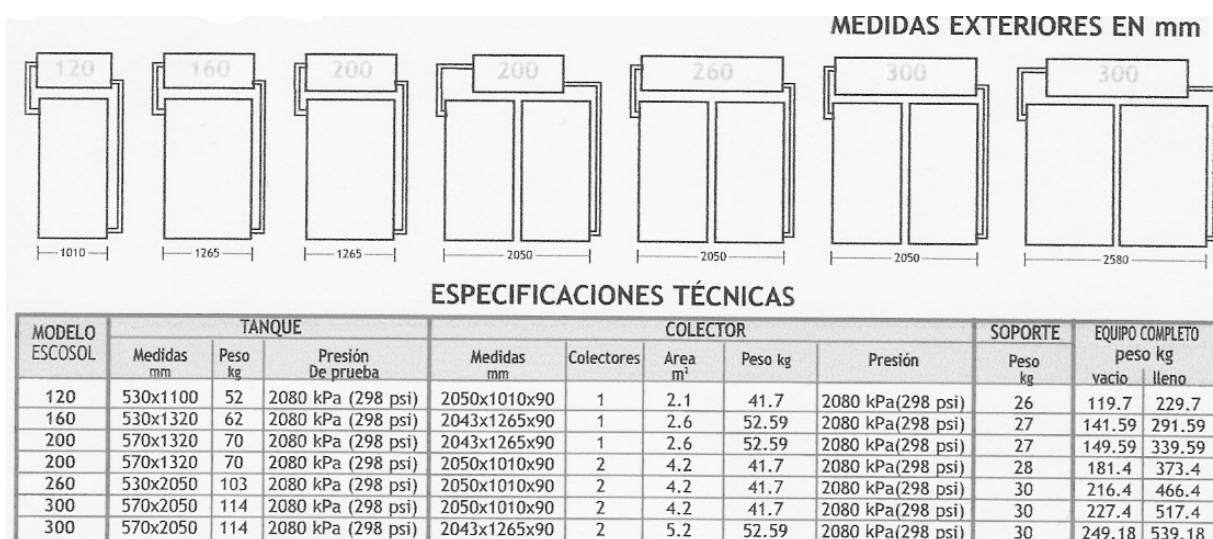
Figura 3.- Especificaciones técnicas de equipos monoblock Escosol de la firma Stiebel Eltron, comercializados en España por Salvador Escoda.
