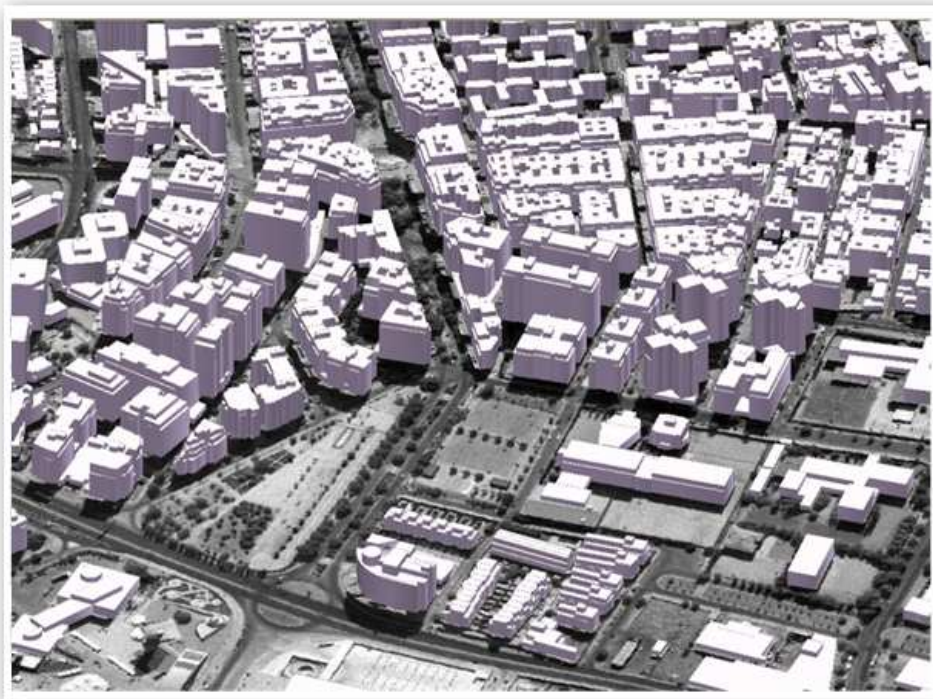
Figura: Administración Local - experiencia C. Visualización 3D a partir de la información tratada de alturas en la base de datos catastral.
