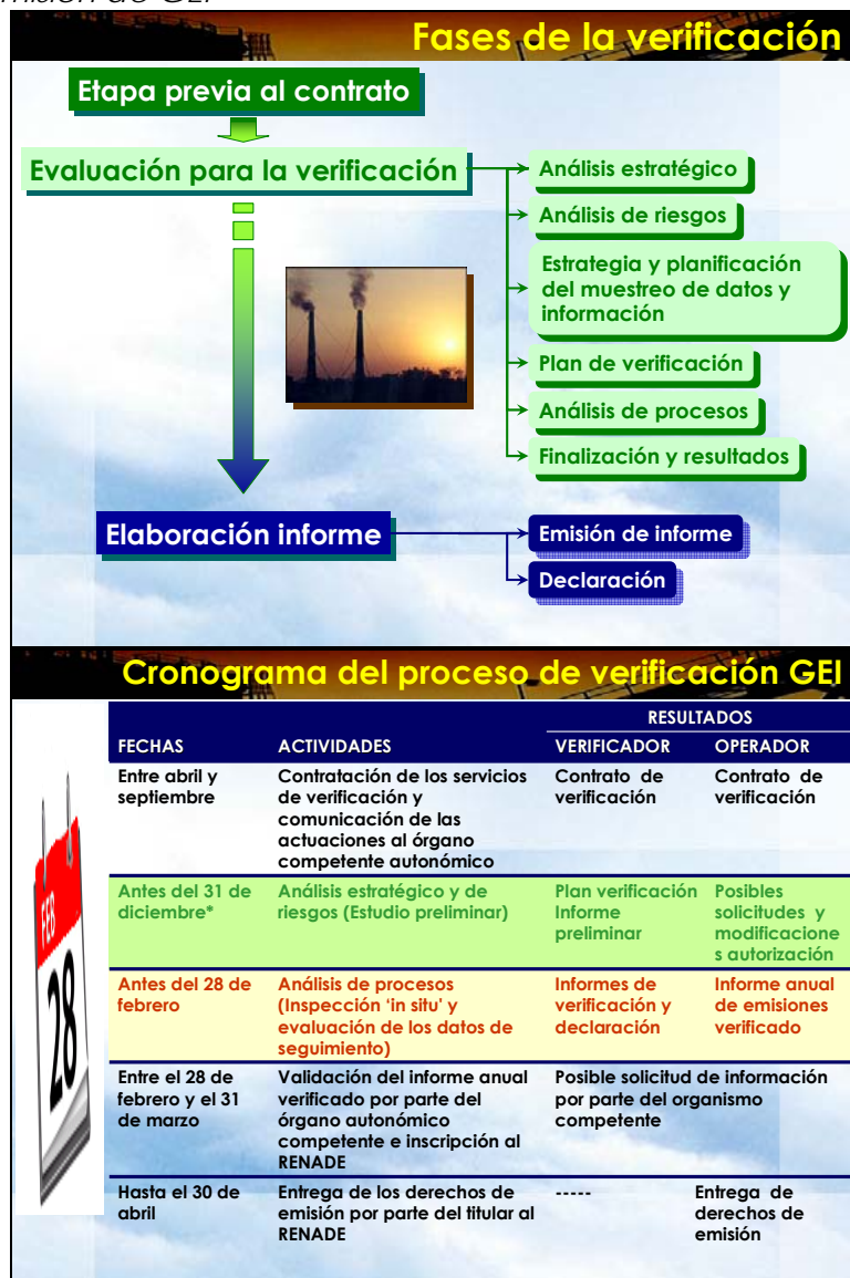
Figura 2.- Diagrama de flujo y cronograma del proceso de verificación del informe de emisión de GEI
