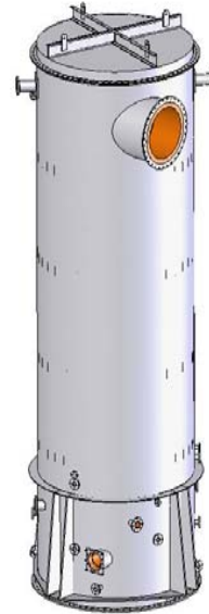
Cámara de refinado del gas
